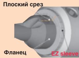
Выровняйте шкалу на периферии втулки EZ по центру фланца сверла. На рисунке, показанном ниже, втулка установлена так, что чистовой диаметр будет увеличен на 0,4 мм
