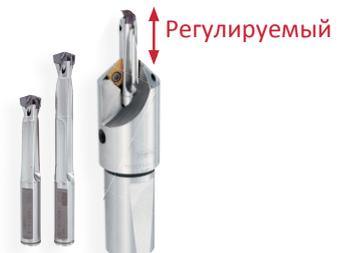
Сверла, предназначенные для выполнения отверстий глубиной 3D–5D и диаметром от 7,5 мм, можно использовать вместе с оправкой, которая позволяет регулировать его глубину, а также высоту и угол фаски. В данном случае существенно сокращается время обработки деталей, так как отверстие, фаска для захода резьбы или операция притупления выполняются за одно врезание.
